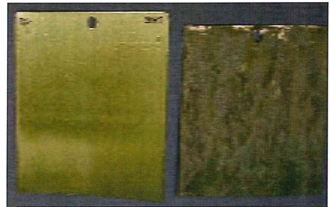
クロム酸処理アルミ板防食性塩水吹付試験 240 時間
